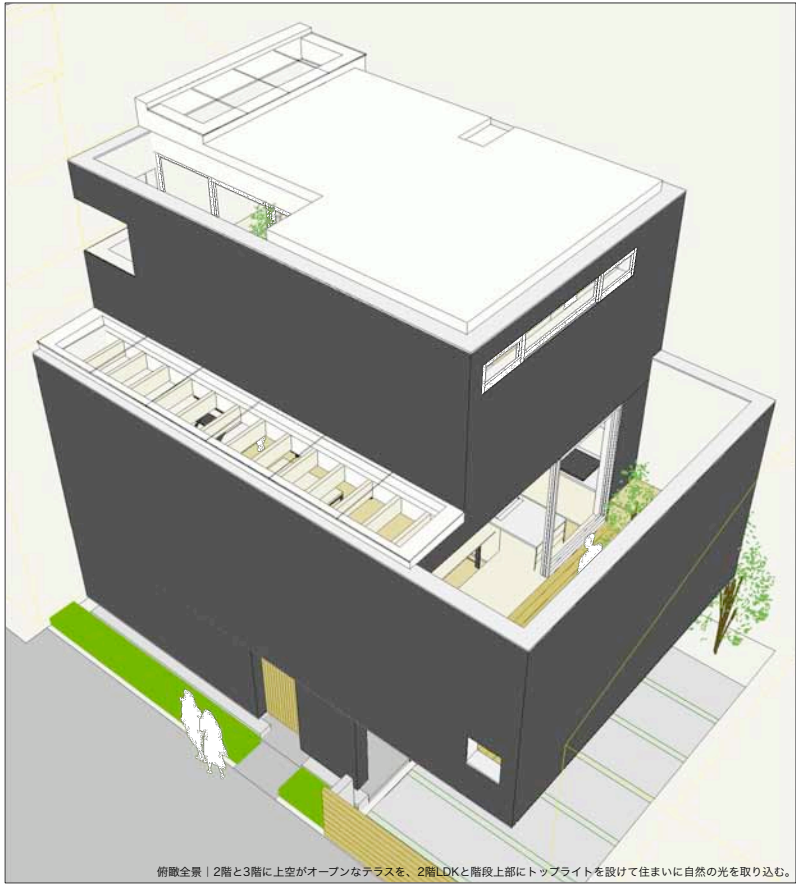
俯瞰全景 | 2階と3階に上空がオープンなテラスを、2階LDKと階段上部にトップライトを設けて住まいに自然の光を取り込む。
